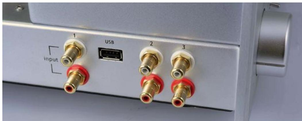
USB-A statt USB-B am D/A-Wandlereingang – dafür gibt es sogar Adapter (USB-B-Buchse auf USB-A-Stecker), wenn man ein wenig recherchiert. Die Cinchbuchsen sind so solide, wie sie aussehen, was auch für das ganze Verstärkergehäuse und die Metall-Fernbedienung gilt.
